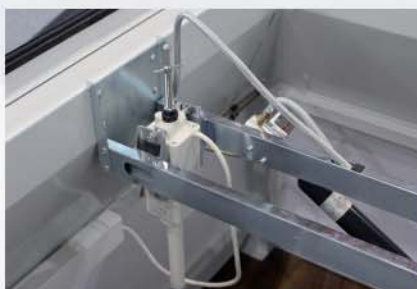
Separater Motor zur Lüftungsfunktion
